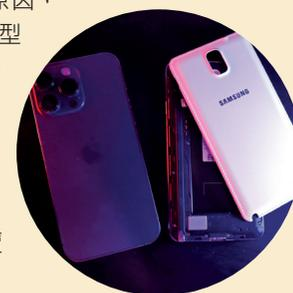
◆現時手機大多一體化設計(圖左)，反觀以前的手機，用戶能自行更換電池。(圖右)(楊景輝攝)
